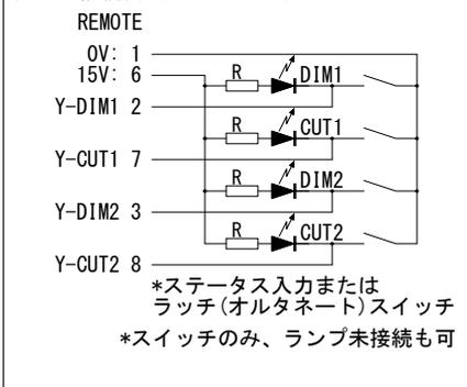
**注意:** 一部のDC入出力型機器との接続では、本製品DIM/CUTの動作時に若干の“ブツ”というノイズを生じる場合があります。DC入出力機器の中にはわずかな直流電流が入出力に洩れているものがあり、この直流電流が本製品のリレーパッシブ回路のDIM/CUTの動作時に変化するためです。本製品からDC入力型のパワーアンプに直接接続する場合などが該当しますのでこの点を気に留めてください。
