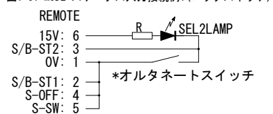
図1: ST MODE ステータス入力接続例1(ロックスイッチ)
